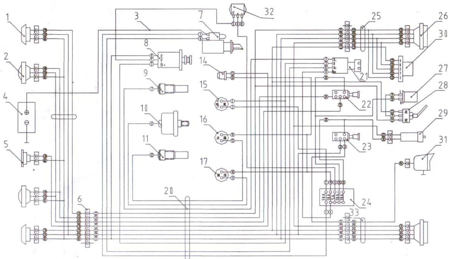
1. Передняя сигнальная лампа. 2. Положительный кабель аккумулятора. 3. Аккумулятор. 4. Аккумулятор. 5. Электрический гудок. 6. Передняя электропроводка. 7. Мотор стартера. 8. Генератор. 9. Электротермическая заглушка. 10. Датчик давления масла. 11. Датчик
