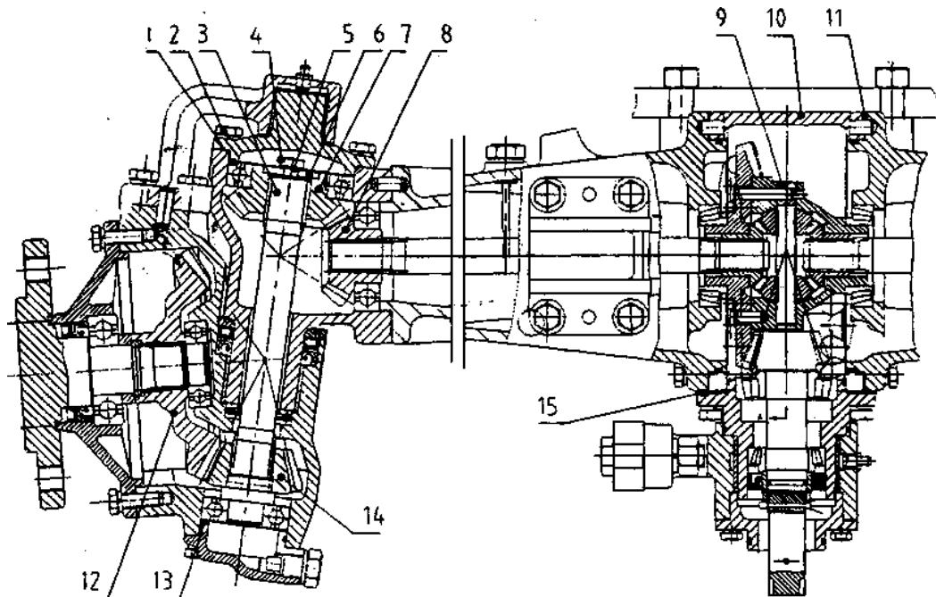
Рис. 9. Схема передней ведущей оси.
