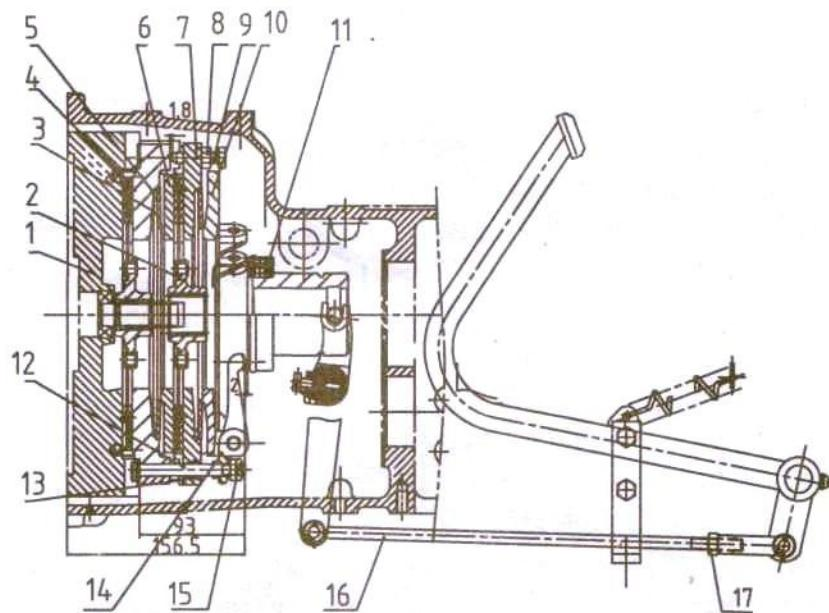
Рис. 4. Сцепление соединяющего типа с двойственным действием.
