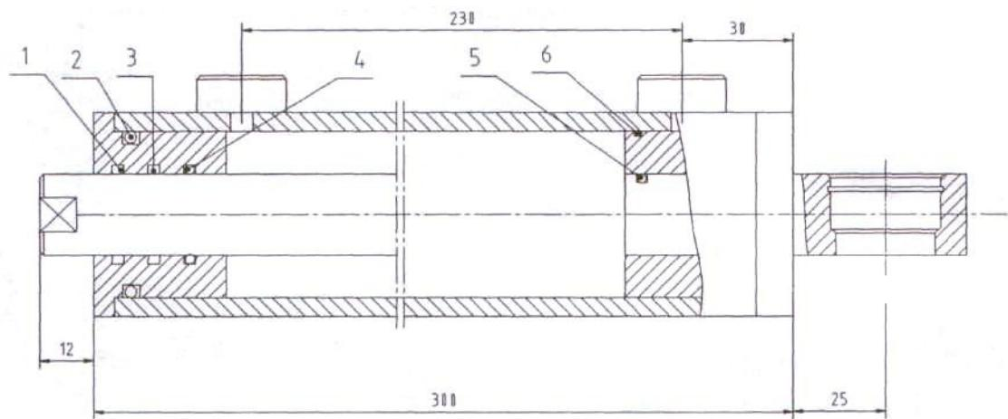
**Технические характеристики цилиндра рулевого механизма.**
