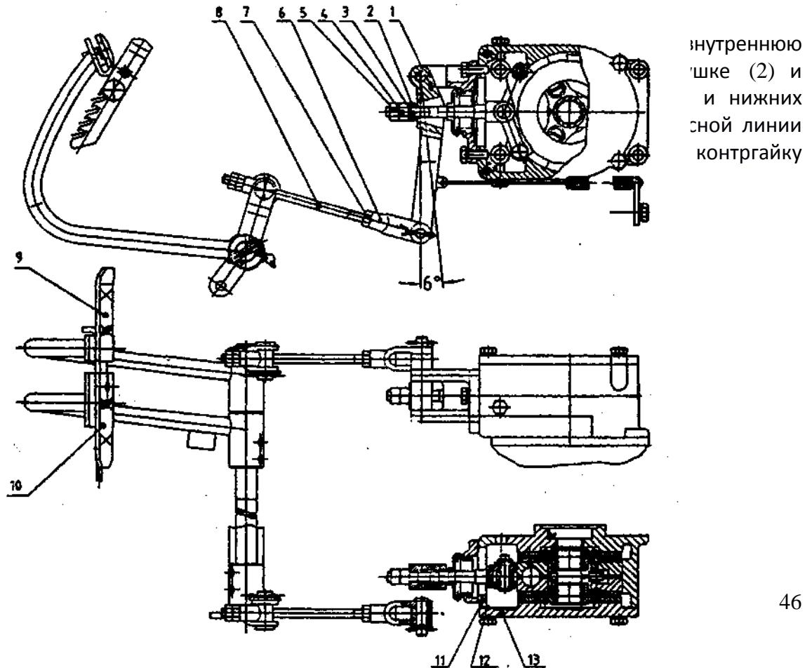
Рис. 13. Регулировка дискового торможения.
