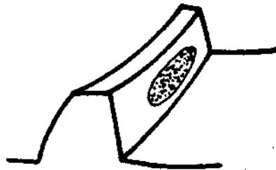
Рис. 8. Отпечаток зацепления конических передач.
