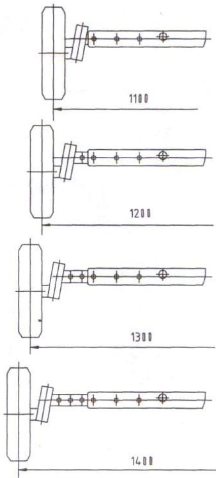
Рис. 6. Регулировка расстояния между серединами колес передней оси.
