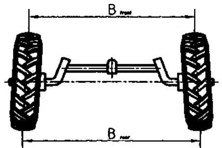
При работе, развал схождения будет меняться из-за деформации и износа деталей передней оси, поэтому необходимо вовремя производить регулировку, в противном случае, направляющие колеса будут быстро изнашиваться.
