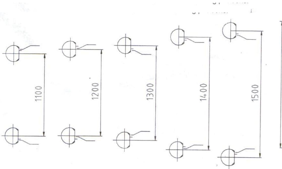
Рис. 7. Регулировка расстояния между серединами колес задней оси.
