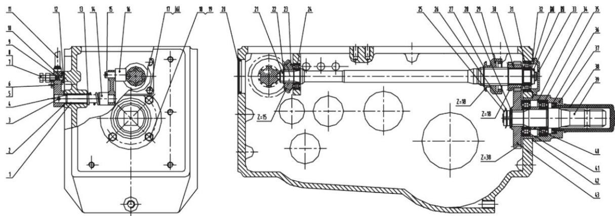
Рис. 3.8. Коробка передач 3×2+1 с задним валом отбора мощности.
