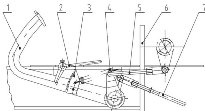
Рис. 2.7. Тормозная система.
