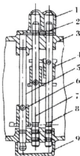
Рис. 3.12. Механизм внутренней блокировки (для коробки  $(3 \times 2) + 1$ ).
