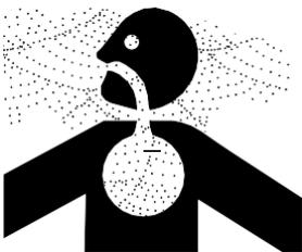
Во время работы двигатель производит выхлопные газы, которые могут быть причиной возникновения болезни или смертельного исхода. При необходимости использования трактора в закрытом помещении, устраняйте газы с помощью удлинителя выхлопной трубы.
