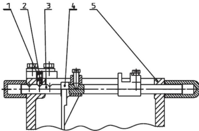
Рис. 3.11. Блокировочный механизм.
