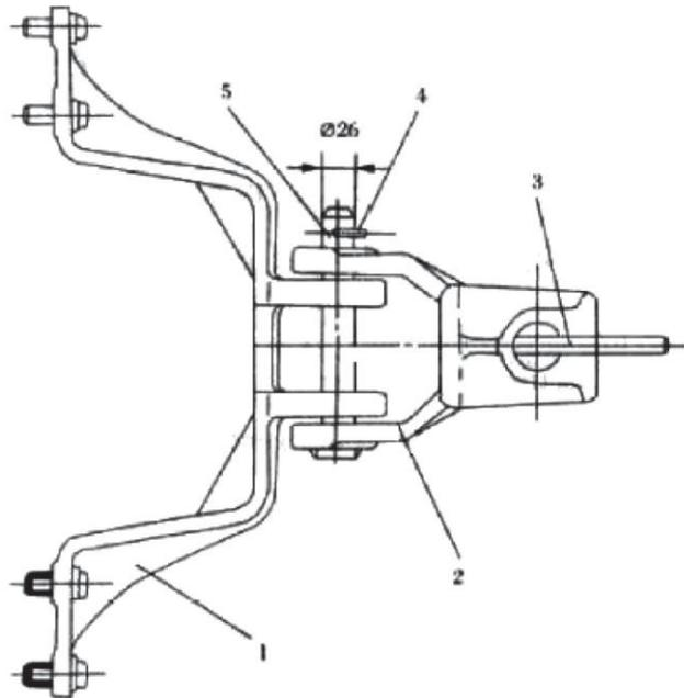
Рис. 3.38. Буксирное приспособление.
