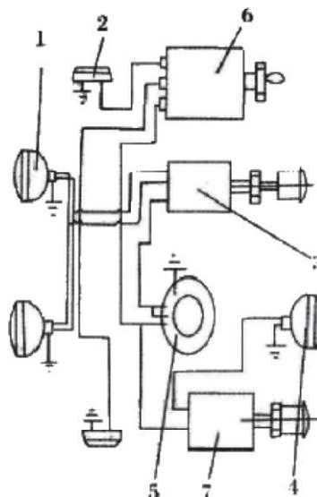
Рис. 3.39. Схема электрического оборудования.
