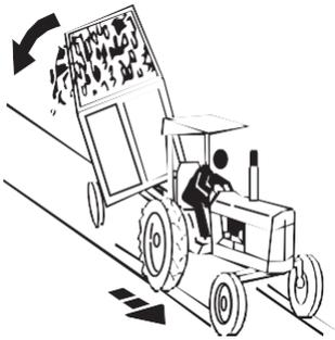
Производите переключение на низшую передачу перед началом спуска с крутого холма в целях улучшения управления трактора с незначительным или вообще без торможения. Используйте двигатель для торможения, чтобы снизить скорость перед началом использования тормозов.
