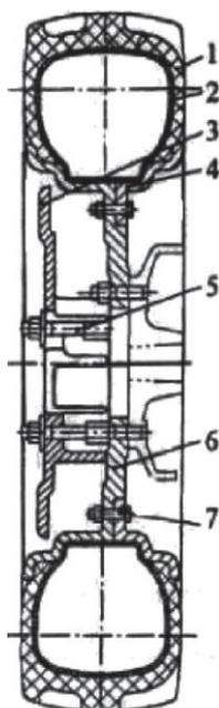
Рис. 3.25. Заднее колесо со сборным ободом обода.
