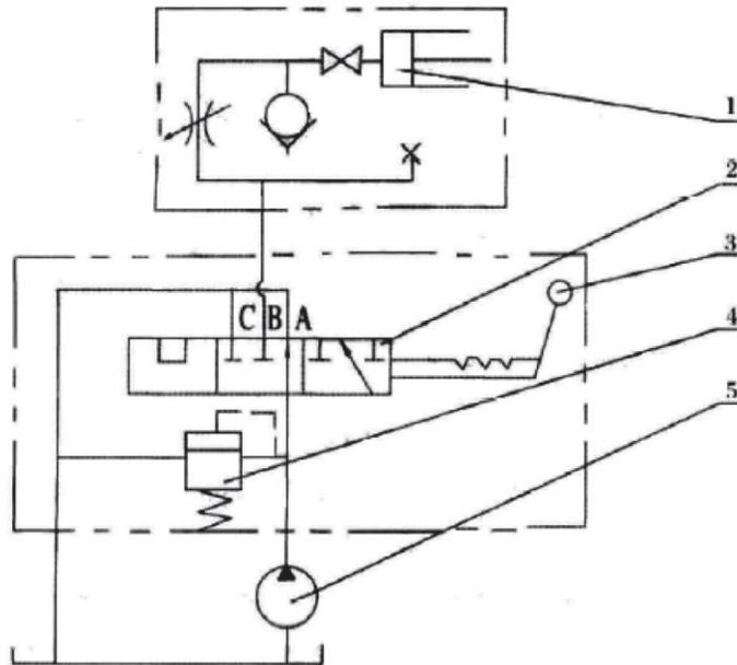
Рис. 3.34. Принцип работы подъемника
