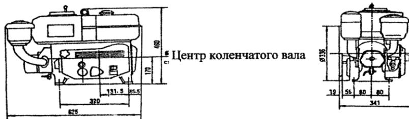
Габаритные и установочные размеры дизельного двигателя
