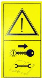
Смислове значення: перед ремонтом, технічним обслуговуванням, регулюванням, слід вимкнути двигун, вийняти ключ запалювання, проводити операції відповідно до вимог, встановлених в керівництві по експлуатації, щоб уникнути тілесних ушкоджень.
