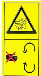
Смислове значення: під час роботи двигуна, не можна відкрити або зняти капот, також протягувати руки в зону роботи, щоб уникнути тілесних ушкоджень.
