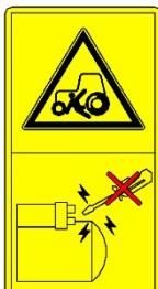
Смислове значення: при запуску двигуна водій повинен сидіти на водійському сидінні, не можна запустити двигун методом короткого замикання контактів стартера, щоб уникнути тілесних ушкоджень.
