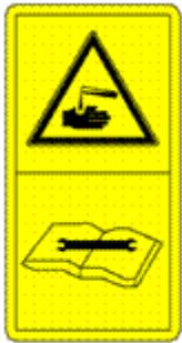
Смислове значення: при проведенні технічного обслуговування акумулятора, див. Правильний порядок технічного обслуговування, встановлений в керівництві по експлуатації.
