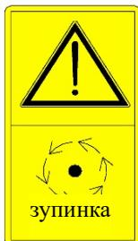
Смислове значення: тільки після повної зупинки всіх рухомих частин машини, допускається контакт з ними, щоб уникнути тілесних ушкоджень.
