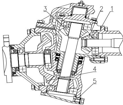
Мал.5.16. Коригування бічній трансмісії переднього приводного моста
