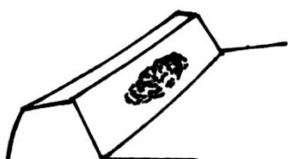
**Рис.8 Отпечаток зацепления конических передач.**
